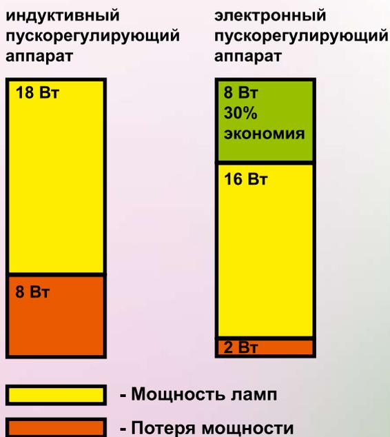
Рис. 11. Сравнение мощности люминесцентных ламп с различными пускорегулирующими аппаратами
