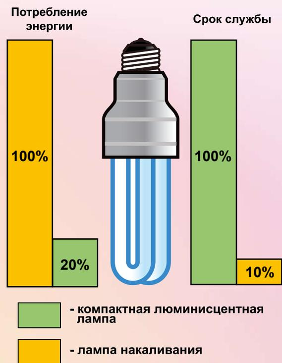
Рис. 10. Сравнение энергопотребления и срока службы компактных люминесцентных ламп и ламп накаливания
