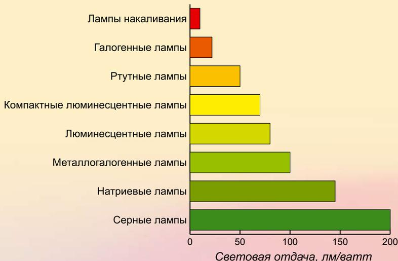
Рис. 2. Световая отдача различных ламп, лм/Вт
