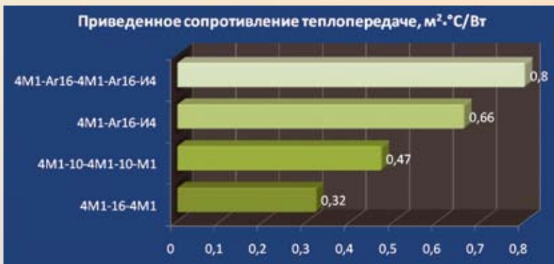
Рис. 4. Приведенное сопротивление теплопередаче различных стеклопакетов
